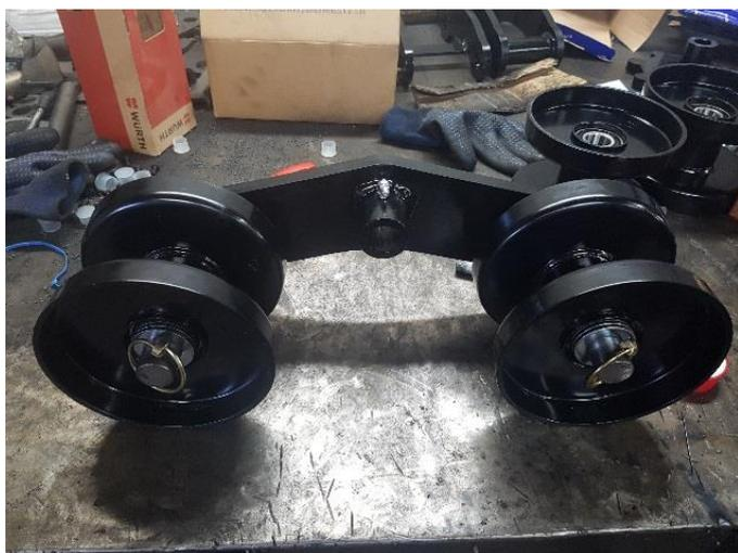
Monter un graisseur à 90° sur la bague du centre puis monter les 2 rollers Ø160 sur les axes directement sur les bagues et avec 2 rondelles avant la goupille.
