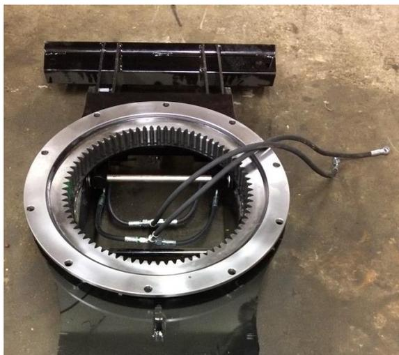
Positionner la couronne d'orientation sur le châssis, puis boulonner avec des vis M12x30 la couronne au châssis du bas (coller toutes les vis lors du montage)
