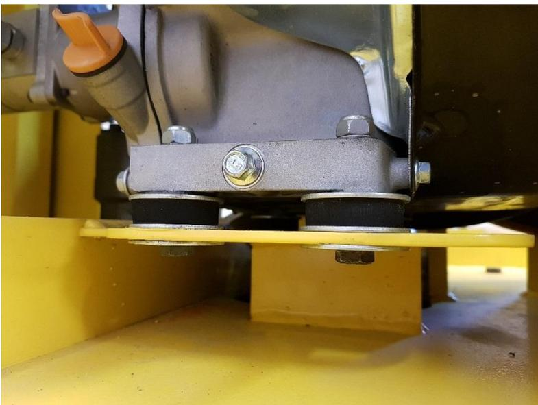
Fixer le moteur sur le châssis avec 4 boulon M8x60, 12 rondelles larges, 4 rondelles caoutchouc et 4 écrous M8 nil stop.
