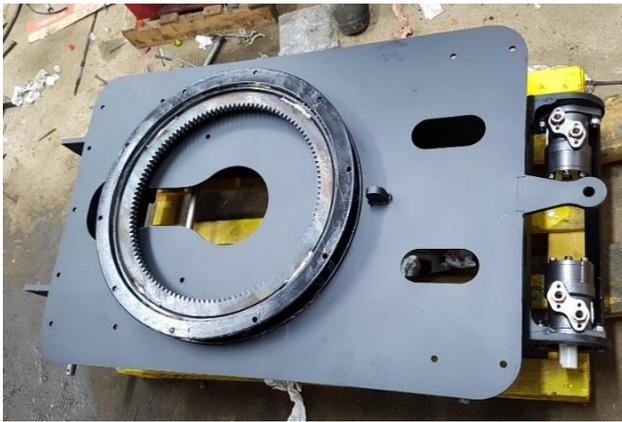
Positionner la couronne d'orientation sur le châssis, attention à ce que la partie soudée à la roue dentée soit fixée au châssis du bas.
