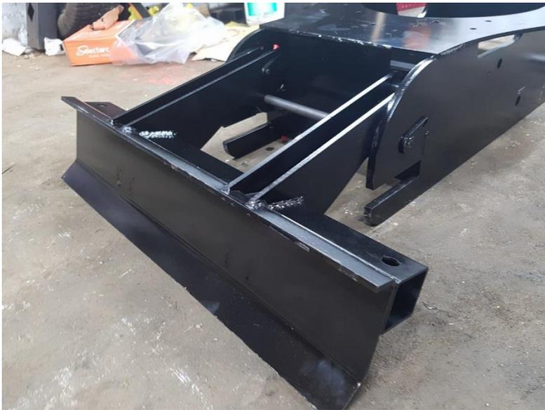
Monter la lame stabilisatrice avec un axe  $\varnothing 25$  lg 450.
