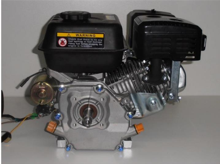
Pour commencer, faire le niveau d'huile dans le moteur thermique, remplir par un des 2 bouchons présents de chaque côté du moteur. A noter que l'un des deux bouchons possède une jauge pour le niveau d'huile.
