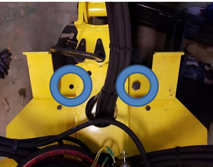
Installer la butée de rotation tourelle sur un des deux trous prévus, vous pouvez intervertir à tout moment le placement de la butée pour avoir un angle d'un côté ou de l'autre.
