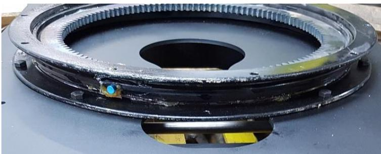
Boulonner la couronne standard avec des vis de M12x35 et des écrous frein. Les têtes de vis vers le dessus.
