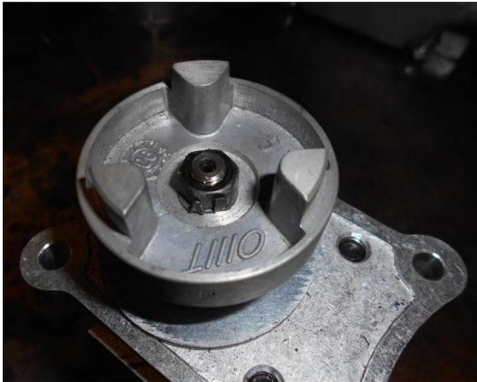
Monter d'abord la rondelle de centrage, puis emboîter le demi-accouplement en faisant bien attention à ce que la clavette ne se retire pas du cône de l'arbre. Prendre un maillet ou une cale en bois et taper doucement pour bien l'enfoncer. Mettre ensuite la rondelle avec l'encoche dans la rainure et visser l'écrou avec du frein filet. Une fois verrouillé, rabattre les 2 encoches de la rondelle sur l'écrou pour que celui-ci ne se desserre pas.
