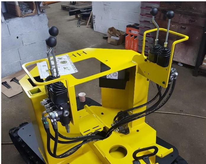
Monter les 2 distributeurs puis sur le châssis puis brancher les flexibles du châssis bas à leur emplacement final sur les distributeurs.
