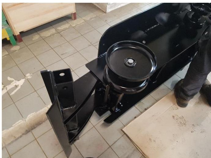
Basculer le châssis sur le côté pour monter les rollers, les triangles et les chenilles.
