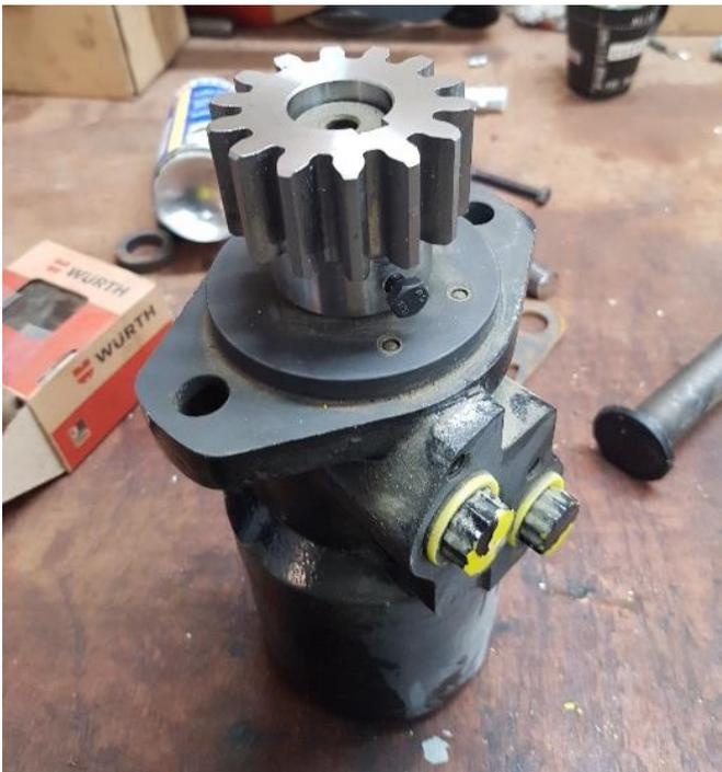
Monter l'engrenage sur un moteur hydraulique :
