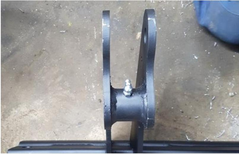
Commencer par monter les graisseurs M6 à 90° sur de chaque côté de la lame et sur les 2 triangles rollers
