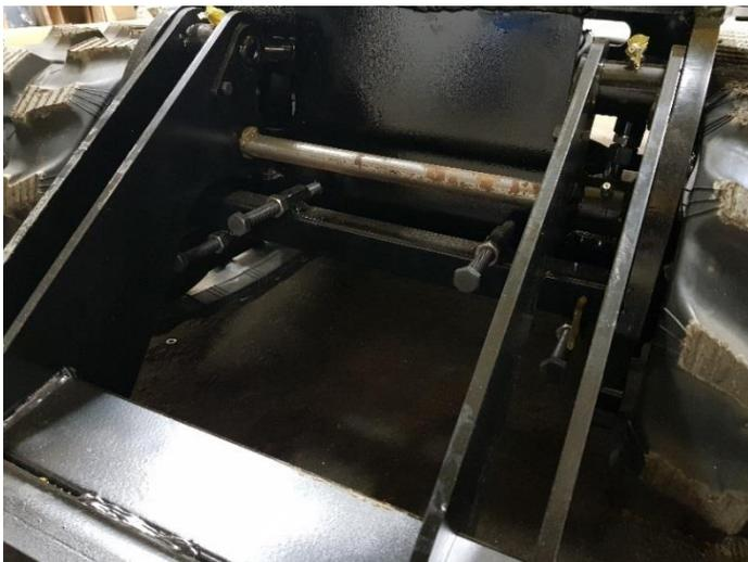
Tendre légèrement les chenilles grâce aux 4 vis tendeur, attendre la fin du montage pour réaliser la tensions finale une fois le moteur hydraulique en huile.
