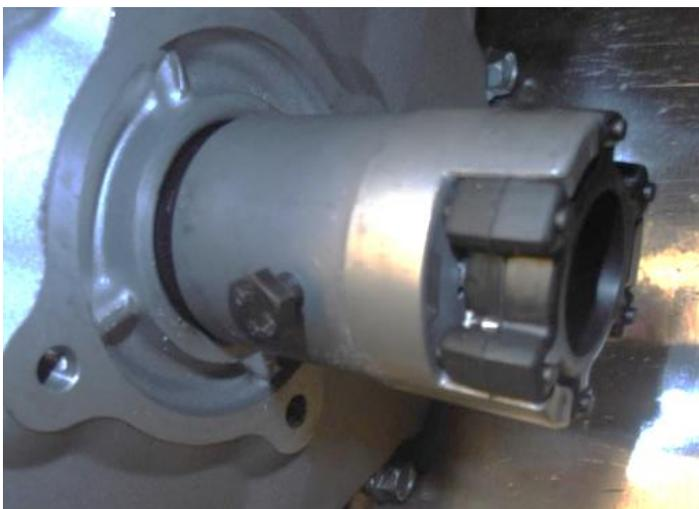
Pour être sûr de votre montage, mettre une vis de bridage directement sur l'accouplement qui tient en pression la clavette (la vis est à coller lors de son montage)
