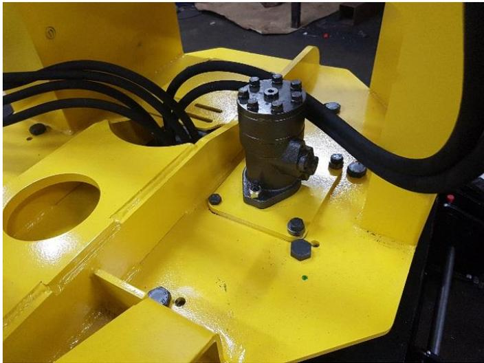
Positionner le moteur hydraulique, attention celui-ci à 2 positions possibles en fonction des couronnes, pro ou standard.
