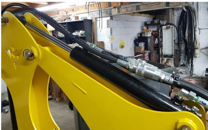
Visser les Raccords rapide sur les flexibles 11 et 12, visser les push pull avec du ruban téflon et bien les verrouiller.
