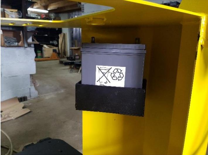
Dans le cas où il y a une option batterie, il est préférable de la mettre dès à présent avec son support, pour cela il suffit de mettre la batterie dans le support et venir visser celui-ci contre le carter.
