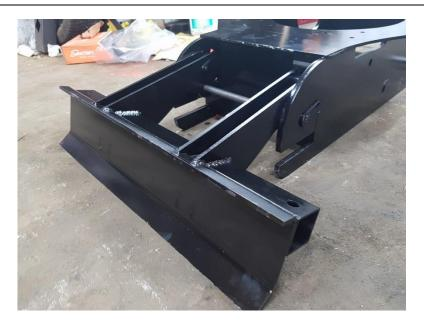
Monter la lame stabilisatrice avec un axe Ø25 lg 450.
