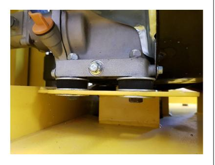
Fixer le moteur sur le châssis avec 4 boulons M8x60, 12 rondelles larges, 4 rondelles caoutchouc et 4 écrous M8 nil stop.
