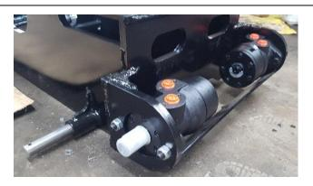
Monter les 2 moteurs hydraulique OMR200 sur le châssis avec 2 vis M12x50 et 2 écrous frein par moteur.
