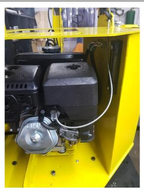
Remonter le filtre à air. Ne pas hésiter à lubrifier le câble pour faciliter son passage.
