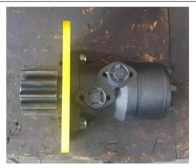
Monter le moteur hydraulique sur la place rotation tourelle, attention au sens de montage du moteur, la plaque est réversible pour couronne pro et couronne standard.
