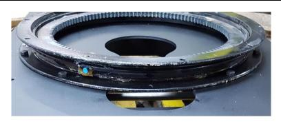
Boulonner la couronne standard avec des vis de M12x35 et des écrous frein. Les têtes de vis vers le dessus.
