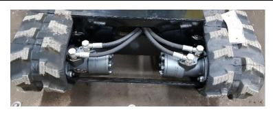
Brancher les flexibles des moteurs hydrauliques en suivant le schéma hydraulique en page 26.
