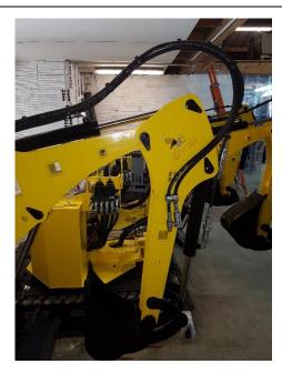
Ligne hydraulique supplémentaire en bout de flèche, ce sont 2 flexibles tirés depuis les distributeurs jusqu'au bras de balancier.
