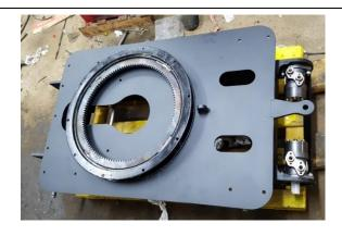
Positionner la couronne d'orientation sur le châssis, attention à ce que la partie soudée à la roue dentée soit fixée au châssis du bas.
