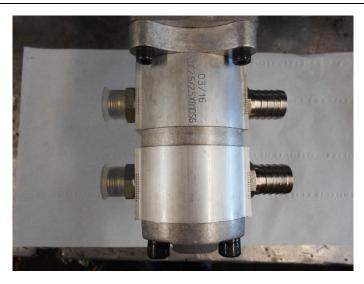
Monter les raccords sur la pompe, 2 raccords UM12L-12x17 coté pression 2 raccords cannelé EC19MC1/2 ou EC19MC3/8 en fonction de la pompe reçue.
