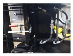
Brancher les flexibles de la lame au 2 T orientés vers le haut du châssis.
