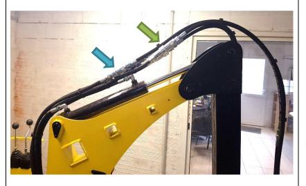
En Vert = Ligne hydraulique pour bras télescopique, Pour alimenter le bras télescopique il vous faut une ligne additionnelle sur le bras de levée et 2 rallonges de flexible (40 cm) pour le vérin de bout de flèche pour compenser l'allongement du bras.
