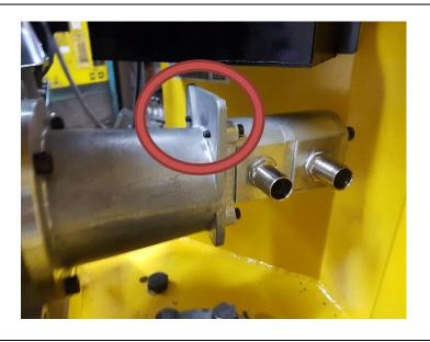
Pour finir, visser la lanterne sur le moteur thermique. (Ne pas mettre les raccords pour le moment)
