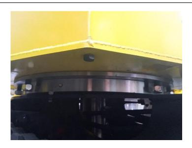
Mettre la vis de vidange de M12 x 20 avec du ruban téflon sous le réservoir, bien serrer celle-ci pour ne pas perdre d'huile lors du remplissage.
