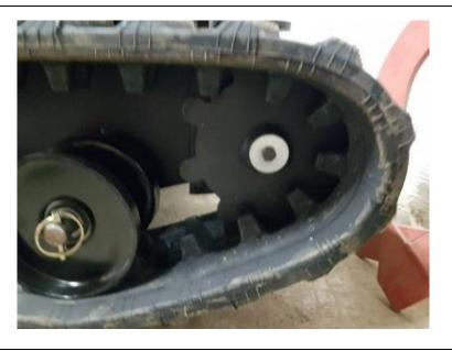
Placer la chenille sur les rollers puis positionner l'engrenage dans la chenille et tirer sur la chenille pour emboiter l'engrenage sur l'arbre du moteur hydraulique.
