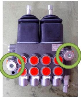
Sur la face avant des distributeurs, démonter les bouchons en acier qui sont en façade puis les remonter sur les côtés du distributeur à la place des bouchons plastique rouge.
