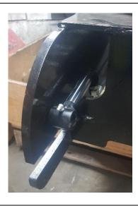
Placer les vérins de 25x40 c 100 dans le châssis, les raccords vers le bas puis fixer l'arrière des vérins avec un axe Ø20 lg 450 verrouiller par une goutte d'eau sur le flanc (coller la vis M6x16).
