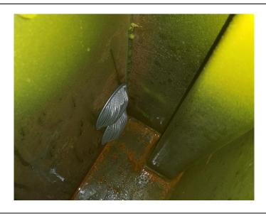
Visser les 2 crépines plate dans le réservoir avec les embouts cannelés Ø19 - 3/8 et une rondelle cuivre dans le réservoir à travers la cloison du réservoir.
