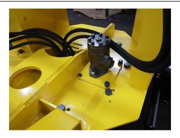
Positionner le moteur hydraulique, attention celui-ci a 2 positions possible en fonction des couronnes, pro ou standard.
