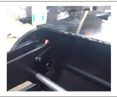
Fixer les têtes de vérins avec 2 axes goutte d'eau Ø 20 lg 60. Verrouiller les gouttes d'eau en collant les vis M6x16.
