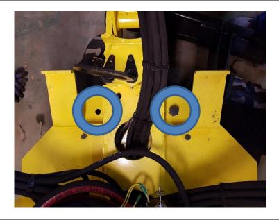
Installer la butée de rotation tourelle sur un des deux trous prévus, vous pouvez intervertir à tout moment le placement de la butée pour avoir un angle max de rotation d'un côté ou de l'autre.
