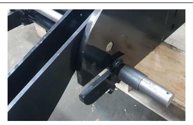
Mettre en place le tendeur avec un tube de chaque côté pour déporter le roller.
