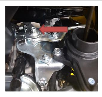
Desserrer l'écrou de bridage de l'accélérateur jusqu'à ce que la tirette bouge sans résistance.
