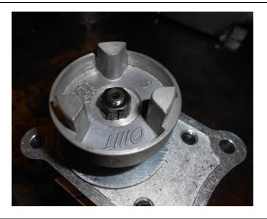
Monter d'abord la rondelle de centrage, puis emboiter le demiaccouplement en faisant bien attention à ce que la clavette ne se retire pas du cône de l'arbre.
