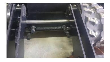
Monter les 4 vis en 16x100 avec un écrou M16 qui permettra de verrouiller le tendeur.
