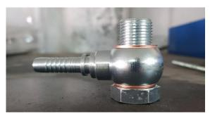
Les vis Bandjo se montent avec 2 rondelles cuivre, une au-dessus et une en dessous de la vis. Les rondelles sont à usage unique, il est préférable de les changer lorsque la vis est enlevée.
