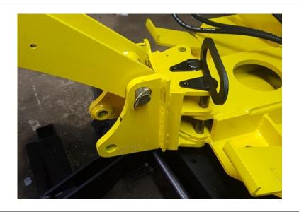
Monter la noix avec un axe Ø25 lg 210 au centre et d'un côté un axe Ø25 lg 210 avec poignée.
