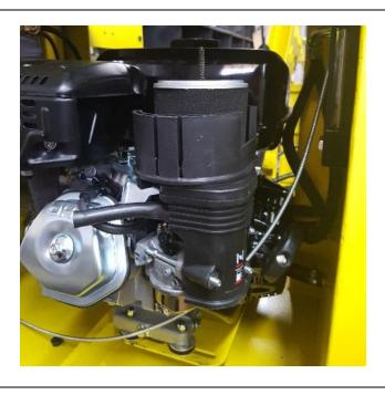
Pour installer le câble de l'accélérateur, commencer par démonter le filtre à air.
