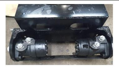
Monter avec du ruban téflon les réduction MC1/2-F3/8.
