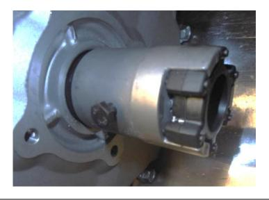
Pour être sûr de votre montage, mettre une vis de bridage directement sur l'accouplement qui tient en pression la clavette (la vis est à coller lors de son montage) Si le perçage taraudage n'est pas fait d'origine, celui-ci est à faire.
