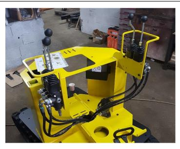
Monter les 2 distributeurs puis brancher les flexibles du châssis bas à leur emplacement final sur les distributeurs.
