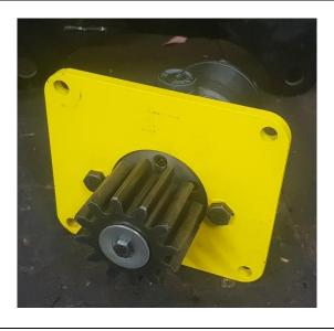
Monter l'engrenage sur le moteur hydraulique puis le verrouiller avec une vis de 8x50 + rondelle large.
