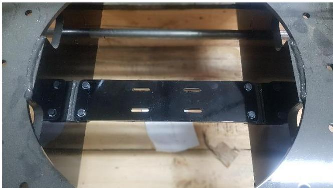
Monter la plaque support JT au centre du châssis.
