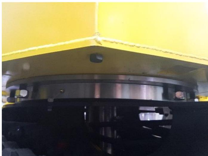
Mettre la vis de vidange de M12 x 30 avec du ruban téflon sous le réservoir, serrer celle-ci pour ne pas perdre d'huile lors du remplissage.
