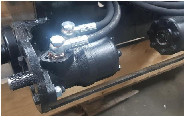
Monter les flexibles des moteurs hydrauliques.
