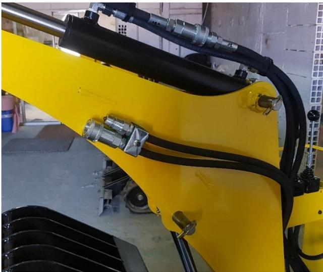
Monter la ligne auxiliaire depuis le distributeur arrière et la fixer sur le bras de levée en attente pour l'alimentation d'un outil auxiliaire.
