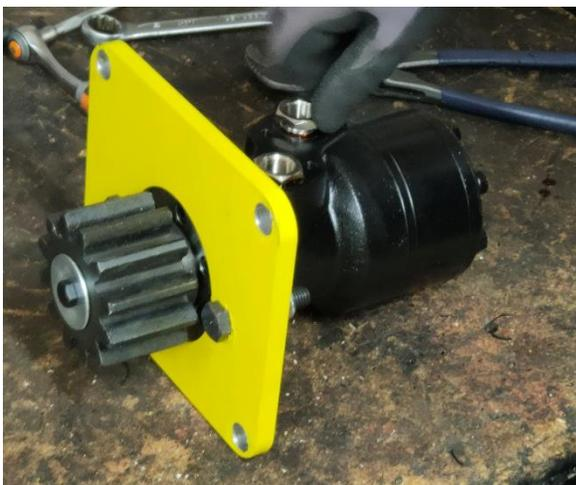
Monter les réductions (avec téflon liquide ou ruban).
