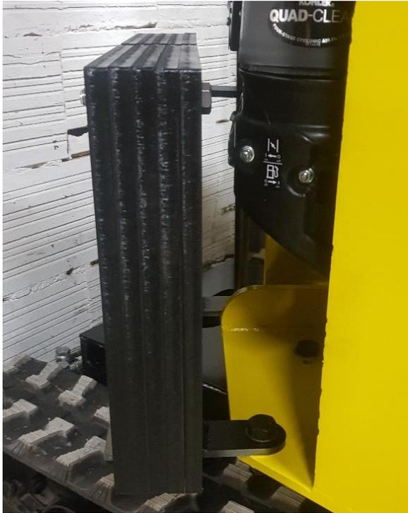
Monter la première plaque contre poids avec l'axe pivot, verrouiller celui-ci avec une vis 6x16 sur le haut de la tourelle.
