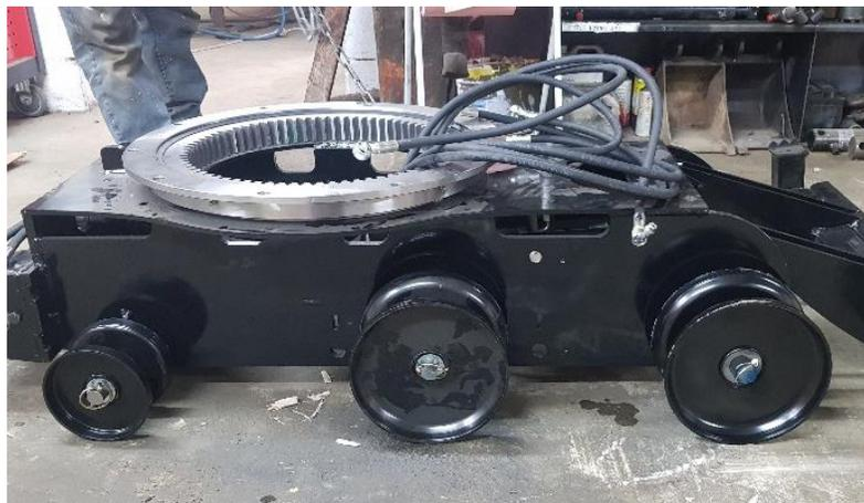
Monter les rollers sur le châssis :
