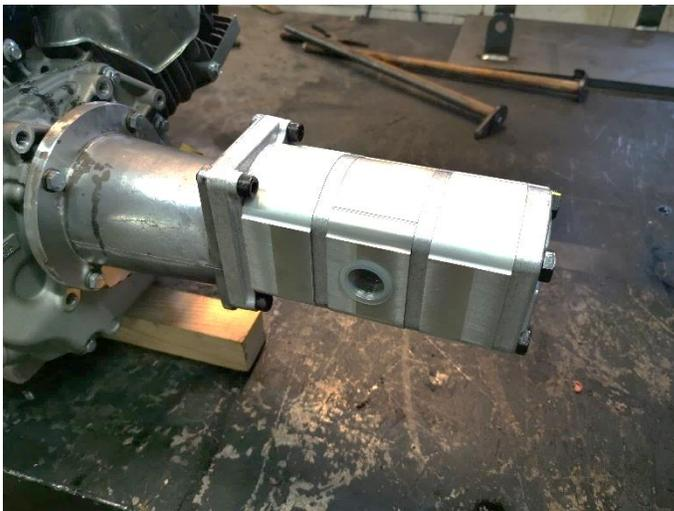
Placer la pompe sur la lanterne avec les 4 vis BTR de 8x30 coller une des vis afin que l'ensemble ne se desserre pas avec les vibrations.
