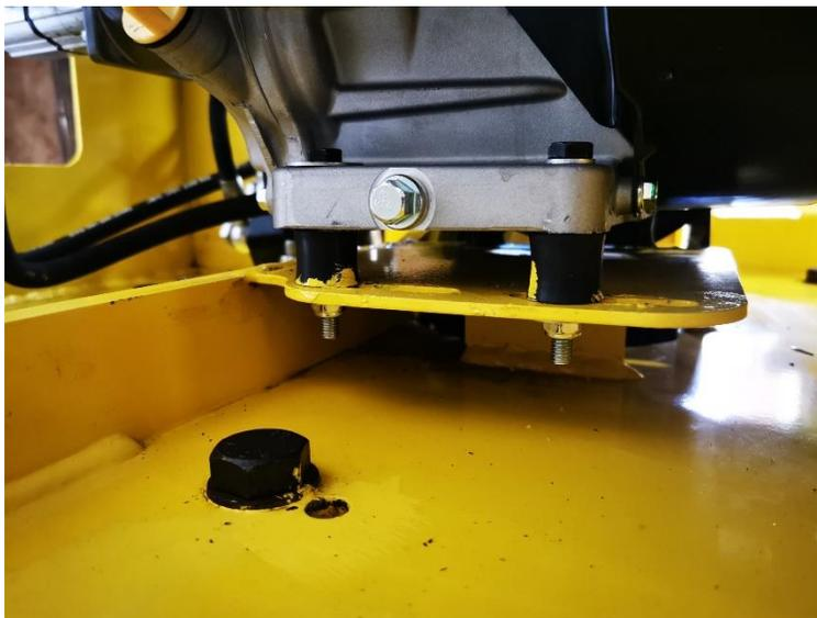
Positionner le moteur thermique sur les silentblocs puis visser le avec des vis de 8x35 + rondelle 8x30.
