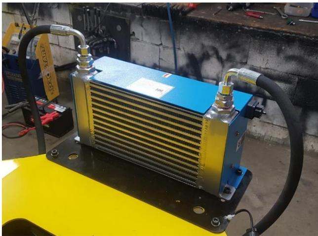
Brancher les flexibles du distributeur au radiateur puis du radiateur au réservoir.
