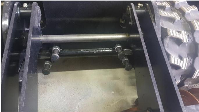
Tendre légèrement les chenilles puis attendre la fin du montage pour réaliser la tension finale une fois les moteurs hydrauliques en pression.
