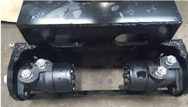
Visser avec du ruban téflon 2 réductions MC1/2-F3/8 par moteur.
