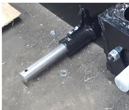
Pour faciliter le montage des rollers, il est conseillé de poncer les axes puis de les enduire de graisse pour ne pas forcer lors de la mise en place.
