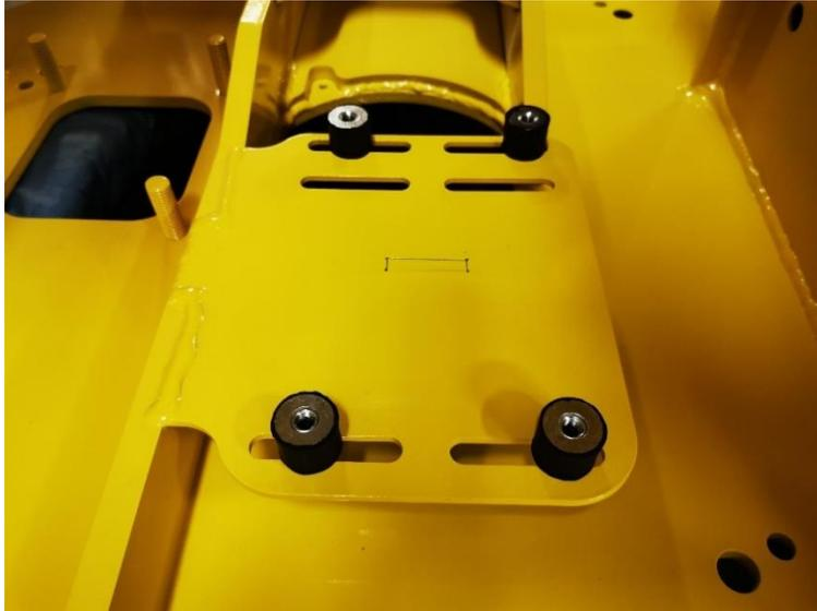
Monter les 4 silentbloc avec 1 rondelle Ø8x30 + écrou frein M8 sur le châssis moteur sans les verrouiller pour le moment
