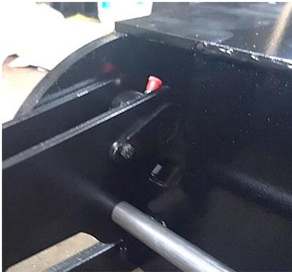
Fixer les têtes de vérins avec 2 axes  $\varnothing 20$  lg 60 avec goutte d'eau.
