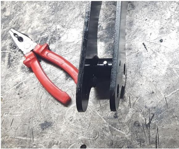
Monter 2 graisseurs M6 droit de chaque côté de la lame stabilisatrice.
