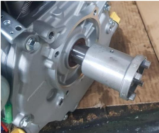
Remonter la clavette sur l'arbre moteur puis emboîter l'accouplement coté moteur en buté sur l'arbre moteur.
