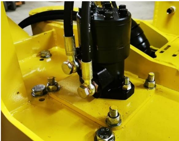
Positionner le moteur hydraulique, faites attention à ce que la dentelure soit bien enclencher.
