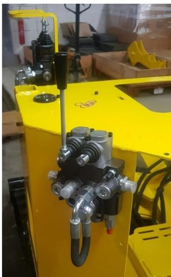
Monter le distributeur 2 éléments en arrière de la tourelle.
