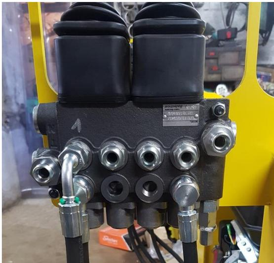
Monter les raccords sur les distributeurs hydraulique
