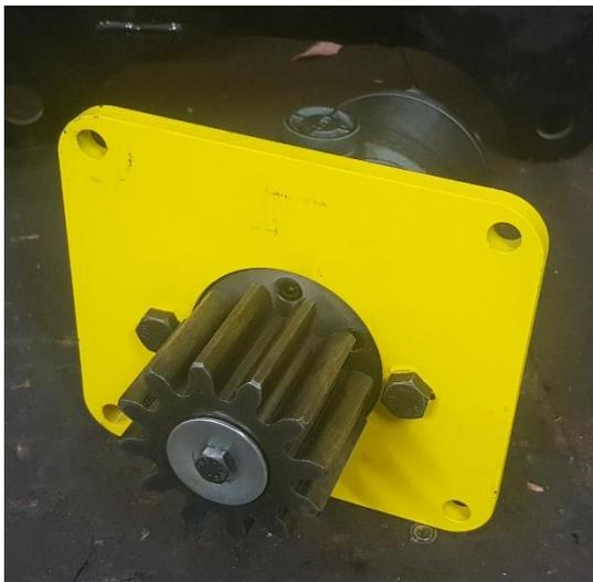
Monter le pignon sur le moteur hydraulique puis le verrouiller avec une vis de 8x40 + rondelle large.
