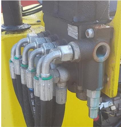
Poser tous les éléments de la pelle au sol, couper le moteur et faites bouger les commandes dans tous les sens pour retirer la pression du circuit.
