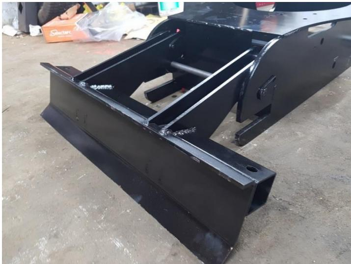
Monter la lame stabilisatrice avec un axe  $\varnothing 25$  lg 435 avec goutte d'eau passant de part en part du châssis.
