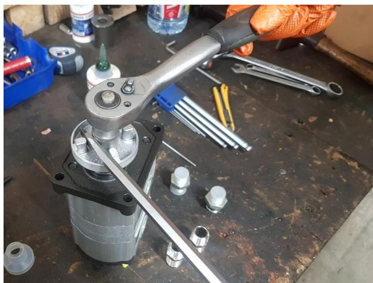
Emboîter le demi-accouplement en faisant bien attention à ce que la clavette ne se retire pas du cône de l'arbre.
