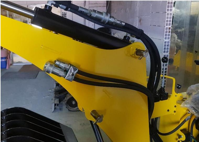
Ligne hydraulique pour bras télescopique, ce sont 2 flexibles tirés depuis le distributeur gauche, remplaçant le bypass des flexibles 15-16 jusqu'au bras de levée pour y raccorder le bras télescopique.
