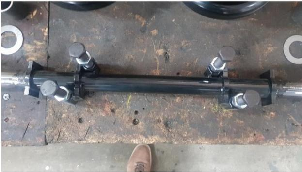
Monter 4 vis en 16x100 sur le tendeur avec un contre écrou sur chaque.
