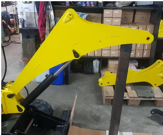
Monter le bras de levée et le vérin de 30/60 c 300 avec les raccords orientés vers le haut.
