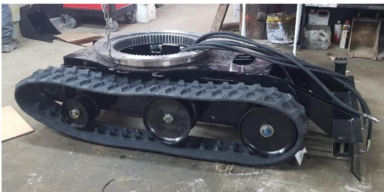
Soulever un côté du châssis ou le châssis complet en fonction des moyens à disposition puis positionner les chenilles.
