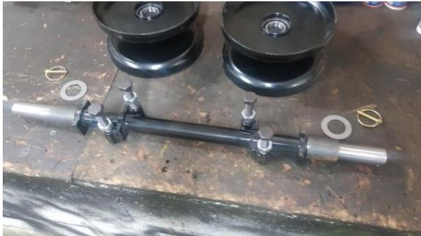
Mettre un tube Ø42 lg 55 de chaque côté pour déporter le roller.
