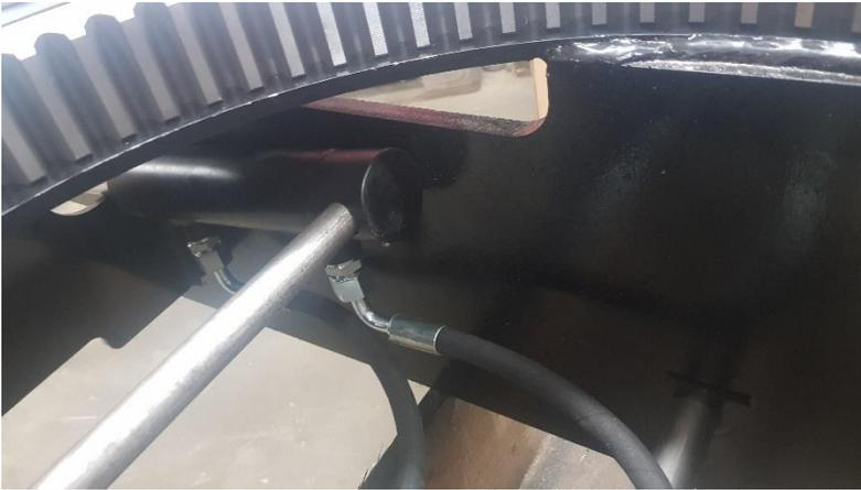
Placer les vérins de 25x40 c 100 dans le châssis.
