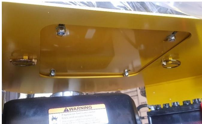
Monter le siège à travers les mortaises présente sur la tourelle et mettre 2 goupilles pour le maintenir en place.
