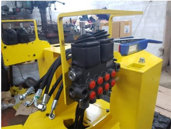
Monter les 2 distributeurs hydraulique.
