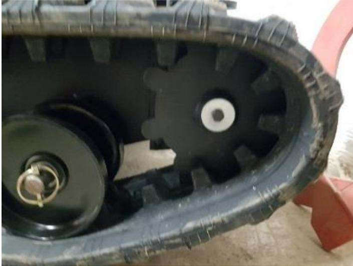
Positionner l'engrenage dans la chenille et tirer sur la chenille pour emboîter l'engrenage sur l'arbre du moteur hydraulique en faisant attention à ne pas perdre la clavette.
