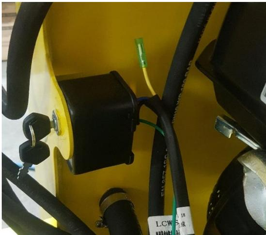
Démonter le contacteur a clé du moteur,
