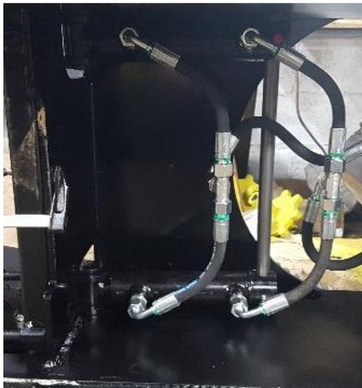
Brancher les flexibles sur les vérins de la lame au Té 12L et les flexible du T12L au distributeur hydraulique. Pour plus d'information, voir schéma page 42-43
