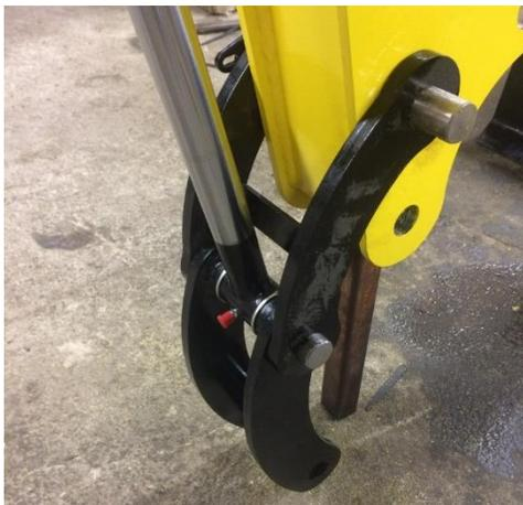
Monter les renvois sur le bras de balancier. Si l'option doigt de manutention a été acheté, l'installer maintenant.
