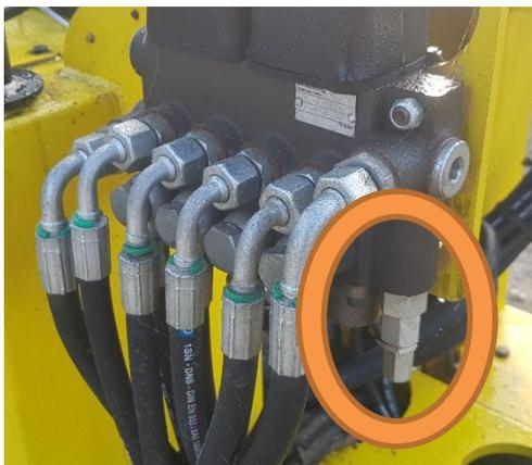
Commencer par repérer la soupape de sécurité, celle-ci indique le point d'entrée de l'huile hydraulique et permet le réglage de la pression de service.
