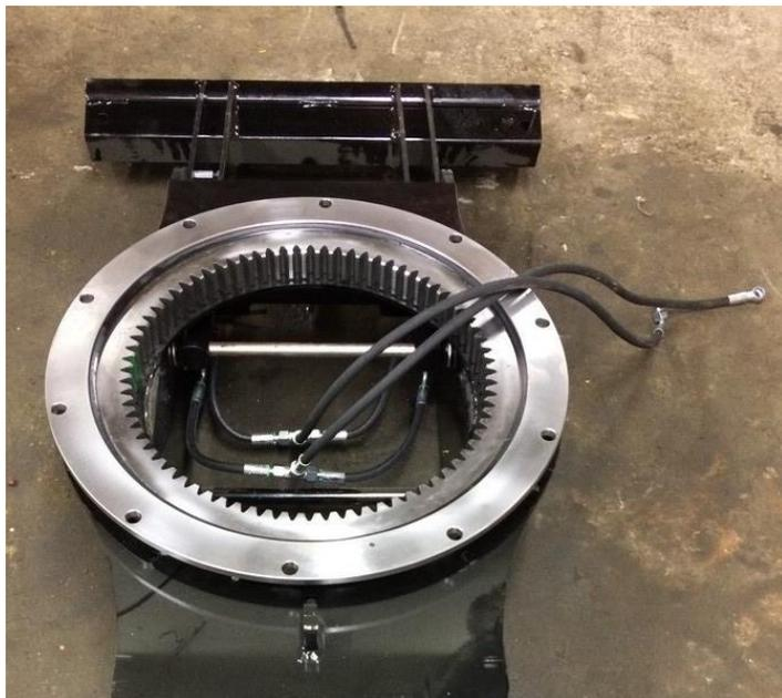
Monter la couronne d'orientation sur le châssis.
