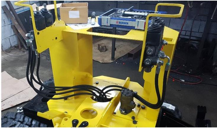
Connecter les flexibles provenant du châssis sur les distributeurs en suivant le schéma de flexible page 42-43.
