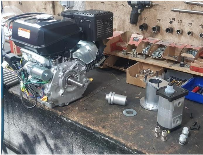
Faire le niveau d'huile dans le moteur thermique, remplir par un des 2 bouchons présents de chaque côté du moteur.
