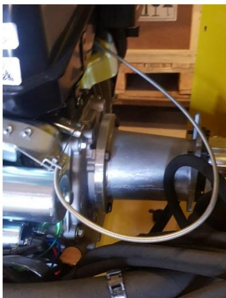
Faire passer le câble dans le guide en faisant une boucle suffisamment large pour que le câble ne force pas à l'usage.
