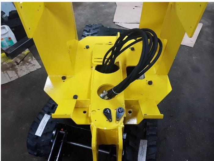
Monter la tourelle sur le châssis en faisant passer les flexibles au centre de la tourelle.
