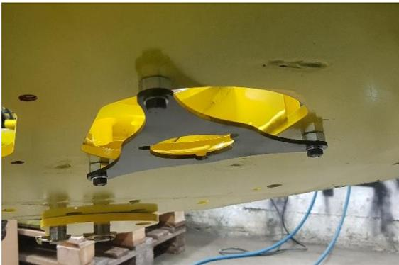
Monter l'étoile pour le joint tournant sous la tourelle avec un écrou M12 entre l'étoile et la tourelle.
