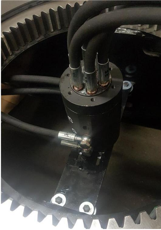
Connecter les flexibles aux moteurs hydrauliques et aux T des vérins de la lame.
