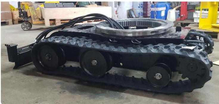
Le montage du joint tournant se réalise une fois la base chenillard terminée, juste avant l'installation de la tourelle.
