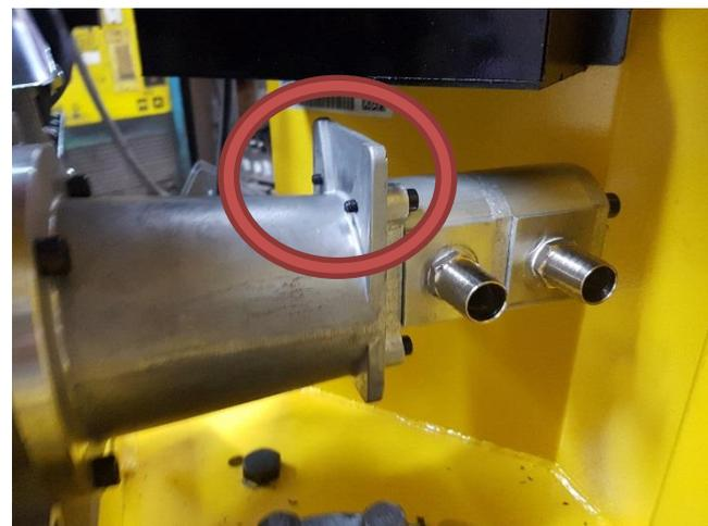
Pour finir, visser la lanterne sur le moteur thermique. (Ne pas mettre les raccords pour le moment)
