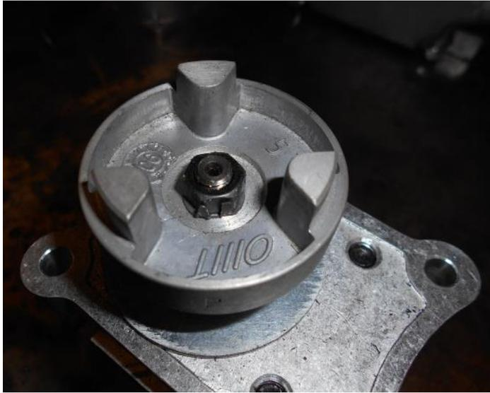
Monter d'abord la rondelle de centrage, puis emboîter le demi-accouplement en faisant bien attention à ce que la clavette ne se retire pas du cône de l'arbre.
