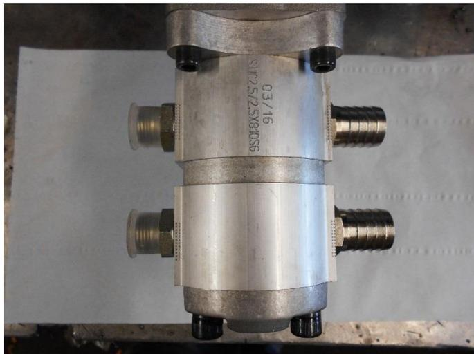
Monter les raccords sur la pompe, 2 raccords UM12L-12x17 coté pression 2 raccords cannelé EC19MC1/2 ou EC19MC3/8 en fonction de la pompe reçue.
