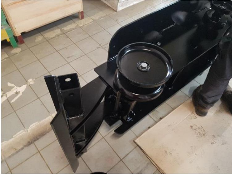
Basculer le châssis sur le côté pour simplifier le montage des rollers et des chenilles.
