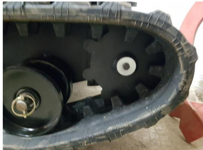
Verrouiller les engrenages de chenilles avec 1 vis 8x50 et 1 rondelle  $\varnothing 8$  large. Coller la vis de 8x50 pour que celle-ci ne se devise pas lors de l'utilisation
