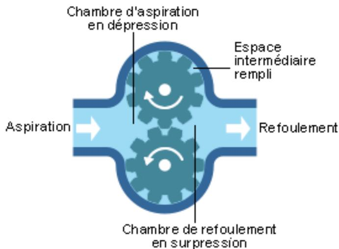
Avant de verrouiller la lanterne, il faut vérifier le sens de rotation de la pompe, pour cela retirer les bouchons de la pompe et tirer doucement sur le lanceur. Regarder d'un côté de la pompe :
