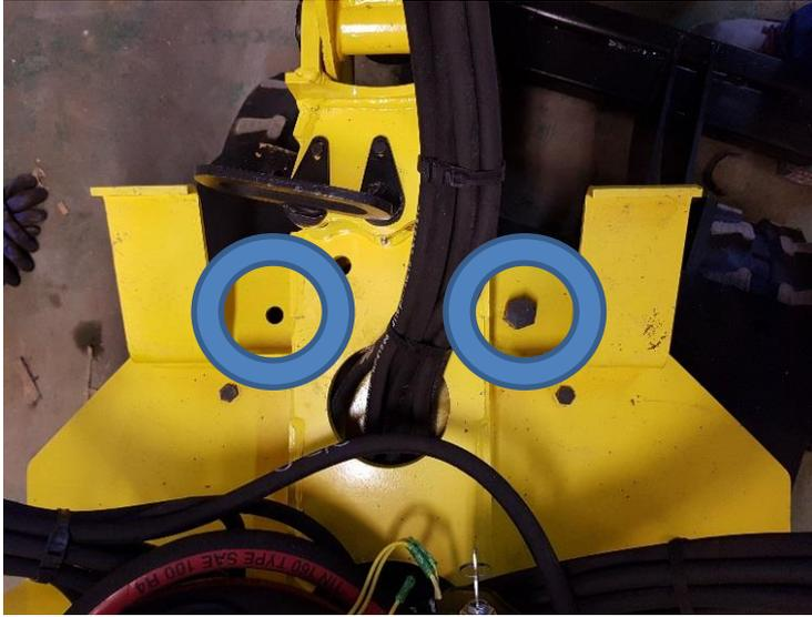
Installer la butée de rotation tourelle sur un des deux trous prévus, vous pouvez intervertir à tout moment le placement de la butée pour avoir un angle d'un côté ou de l'autre.
