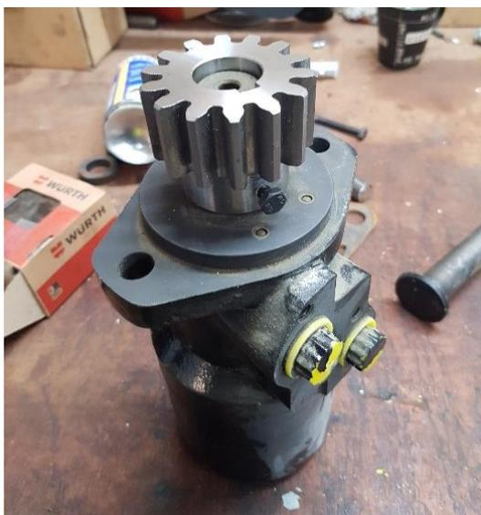
Monter l'engrenage sur un moteur hydraulique :
