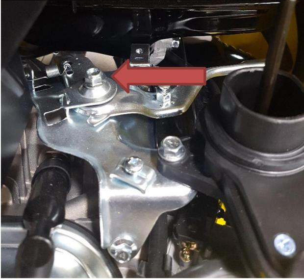
Desserrer l'écrou de bridage de l'accélérateur jusqu'à ce que la tirette bouge sans résistance.
