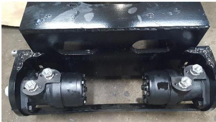
Monter les 2 moteurs hydraulique sur le châssis avec 2 vis M12x50 et 2 écrous Nil stop par moteur.
