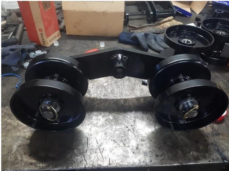
Monter un graisseur à 90° sur la bague du centre du triangle puis monter les 2 rollers Ø160 sur les axes directement sur les bagues et avec 2 rondelles avant la goupille.
