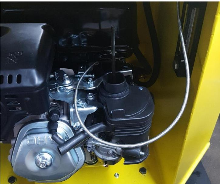
Positionner le câble et pousser l'accélérateur moteur le plus loin possible puis couper le câble avec 1cm en plus
