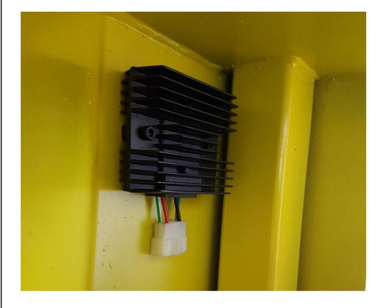
Le moteur Kohler 9.5 cv dispose d'un régulateur de charge, ne pas oublier de connecter celui-ci une fois la batterie branchée.
