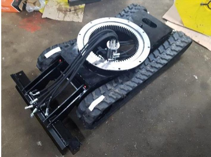
Monter tous les flexibles sur la partie supérieure du joint tournant.
