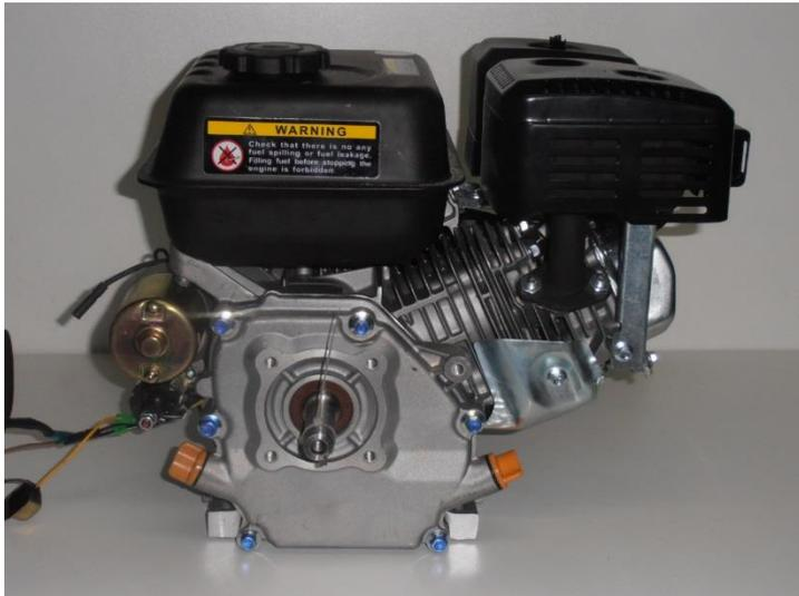
Faire le niveau d'huile dans le moteur thermique, remplir par un des 2 bouchons présents de chaque côté du moteur.
