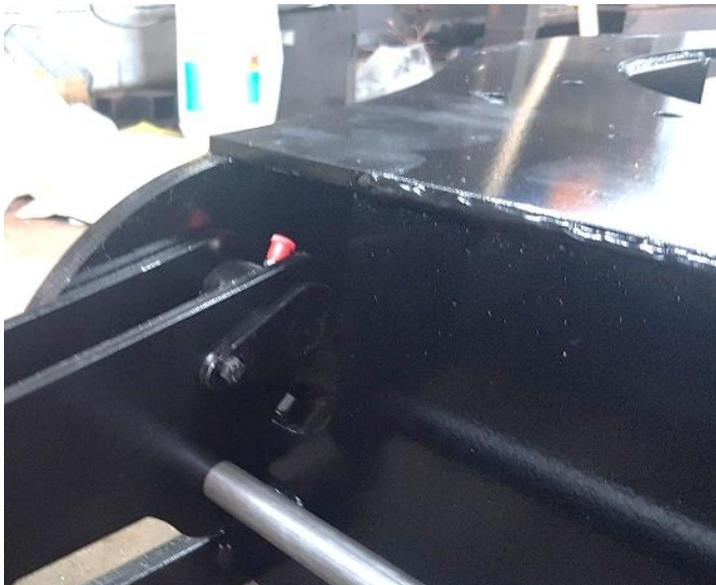
Fixer les têtes de vérins avec des axes goutte d'eau  $\varnothing 20$  lg 60.
