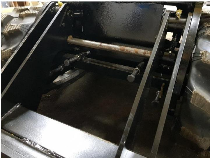
Tendre légèrement les chenilles grâce aux 4 vis tendeur, attendre la fin du montage pour réaliser la tentions finale une fois le moteur hydraulique en huile.
