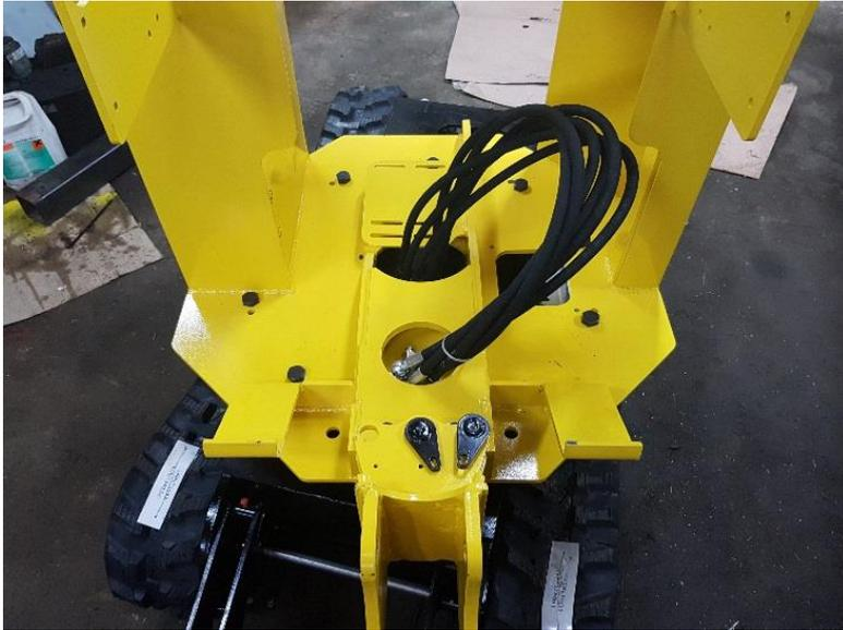
Passer les flexibles dans le centre de la tourelle et en passant dans le cercle de la fixation du joint tournant.
