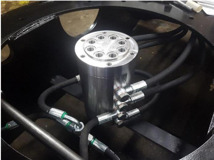
Brancher les flexibles en suivant le schéma hydraulique.
