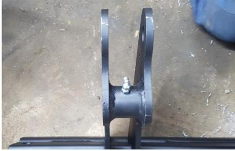
Commencer par monter les graisseurs M6 à 90° sur de chaque côté de la lame
