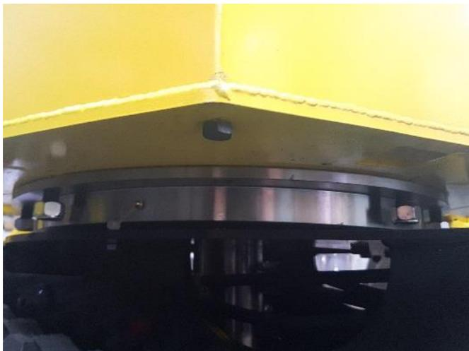
Visser avec du ruban téflon une vis de M12 x 20 sous le réservoir (vis de vidange) et bien serr celle-ci pour ne pas perdre d'huile.
