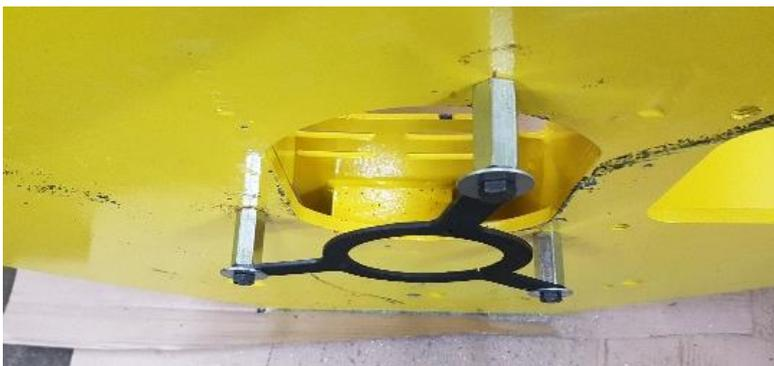
Placer la fixation du joint tournant sur le bas de la plateforme supérieure.
