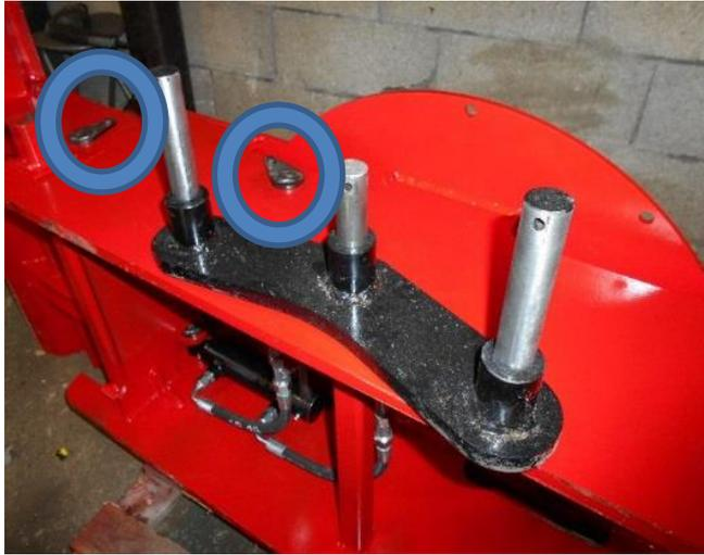
Verrouiller les axes de lame et des vérins avec les gouttes d'eau (en bleu).
