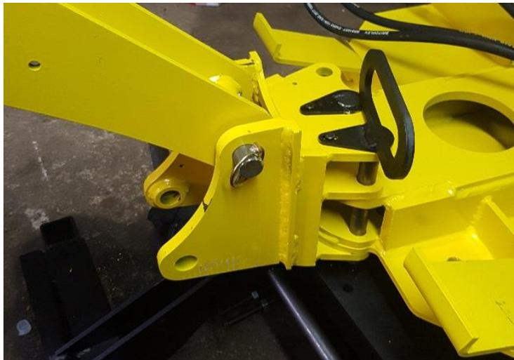
Monter la noix avec un axe  $\varnothing 25$  lg 210 au centre et d'un côté un axe  $\varnothing 20$  lg 210 avec poignée.
