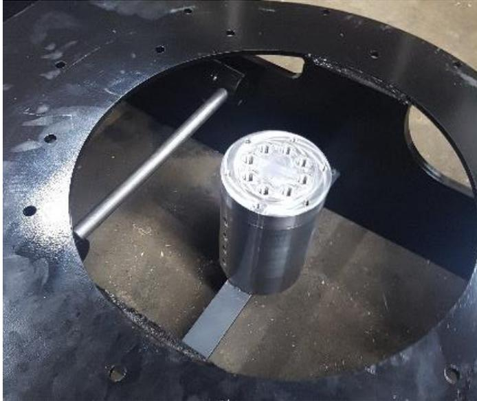
Monter le joint tournant 6 voies sur la barre transversale avec 2 silentbloc ep 40. Le silentbloc est vissé dans le joint tournant mais reste libre sur la barre.
